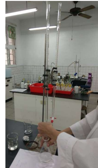
圖六 以NaOH(aq)滴定試體
