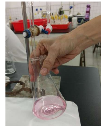
圖七 以NaOH(aq)滴定，直至酚酞指示劑呈粉紅色
