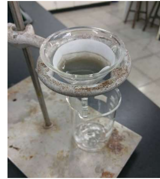
圖四 過濾以HCl(aq)溶解沉積物後的雜質
