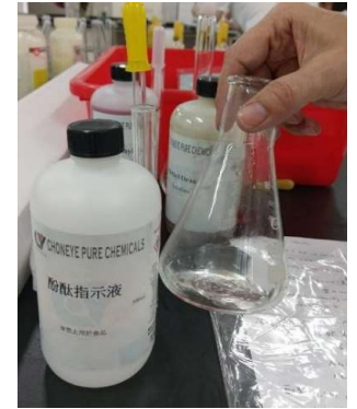
圖五 將酚酞指示劑加入過濾後的測試錐形瓶
