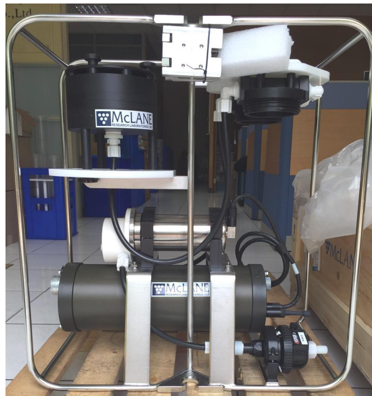
現場海水過濾器
