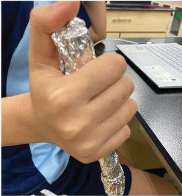
圖三、四 搖晃加入染劑的樣品，使其均勻染色，再將樣品放上玻片放置烘箱烘到乾燥
