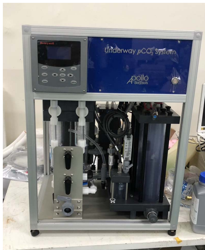
圖 4. 走航式海水二氧化碳分壓測量儀之主系統
