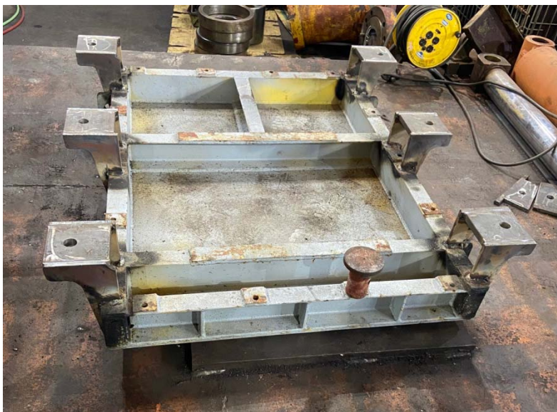
圖 8. 移動式 CTD 絞機底座重新設計符合新研究船甲板鎖點
