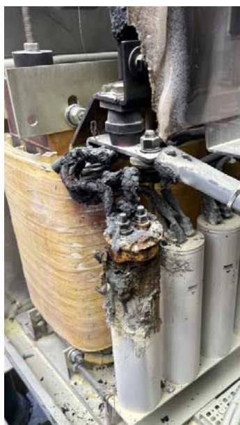
圖16. 友船故障燒毀之零件及待支援的零組件
