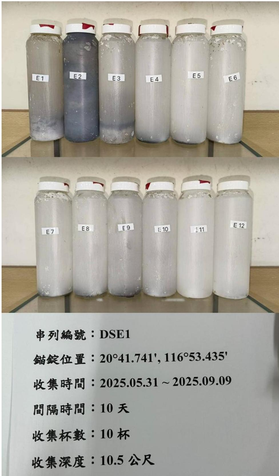
圖 4、DSE1 串列 10.5 m 水深的收集杯沉降顆粒樣本。
