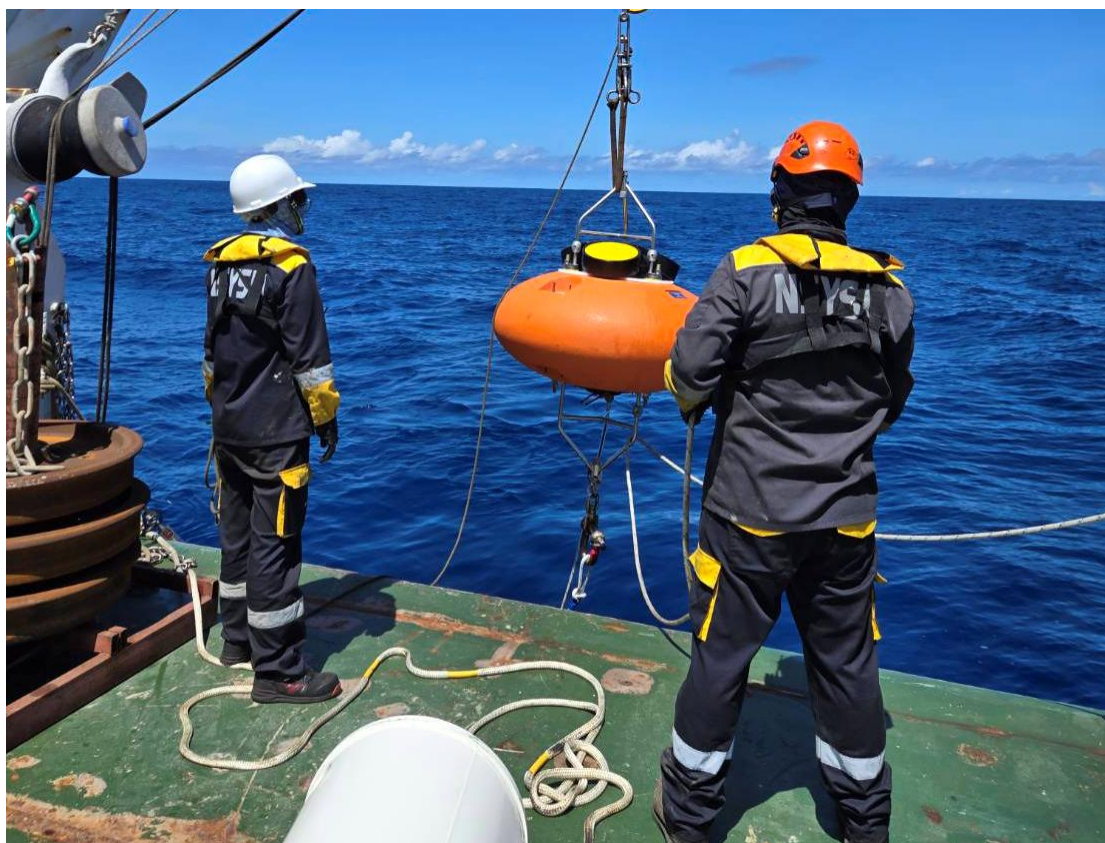
圖 2、NOR3-0279 航次，Aug 09, 2025 於 T 站佈放錨碇式沉降顆粒收集器
