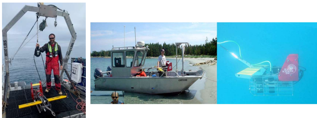
圖 1、Acrobat 系統，甲板上與水面下的照片。
