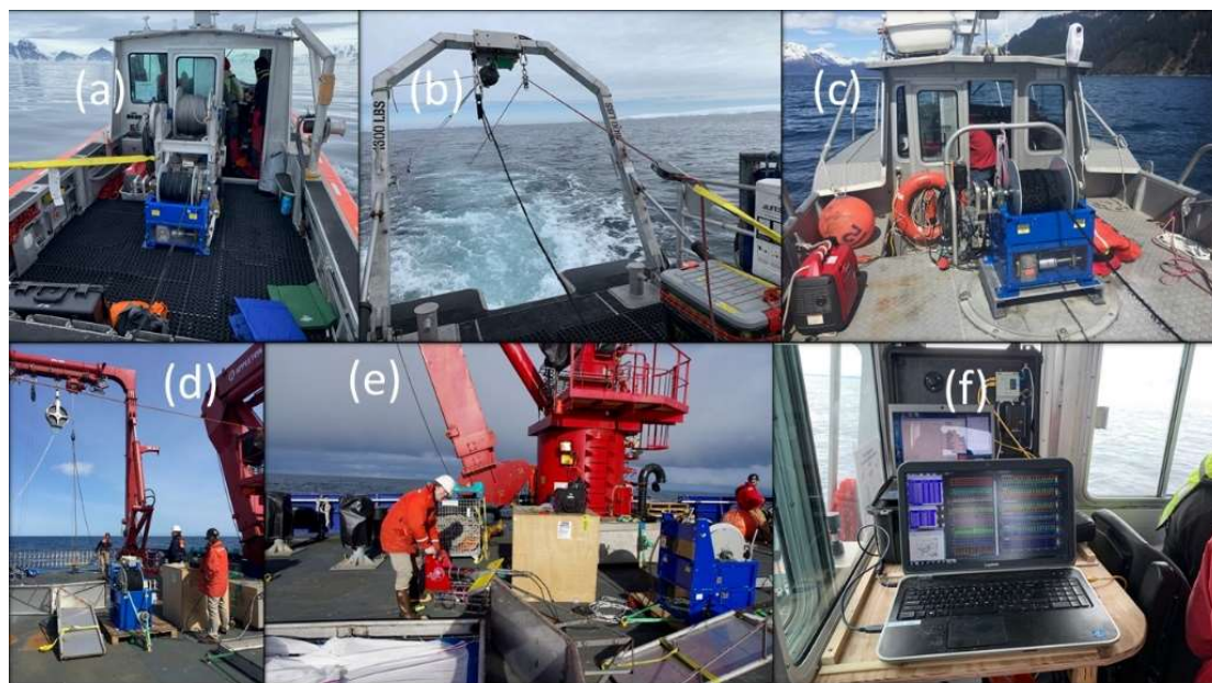
圖 2、(a)–(c) Acrobat 對應的絞機系統與船上 A 架的關係，此船為一般小船。(d)–(e)，Acrobat 與對應的絞機系統於千噸級研究船甲板上的作業畫面。(f)，觀測資料可透過筆記型電腦與 Acrobat 電腦主機連線，取得即時監測的效果。
