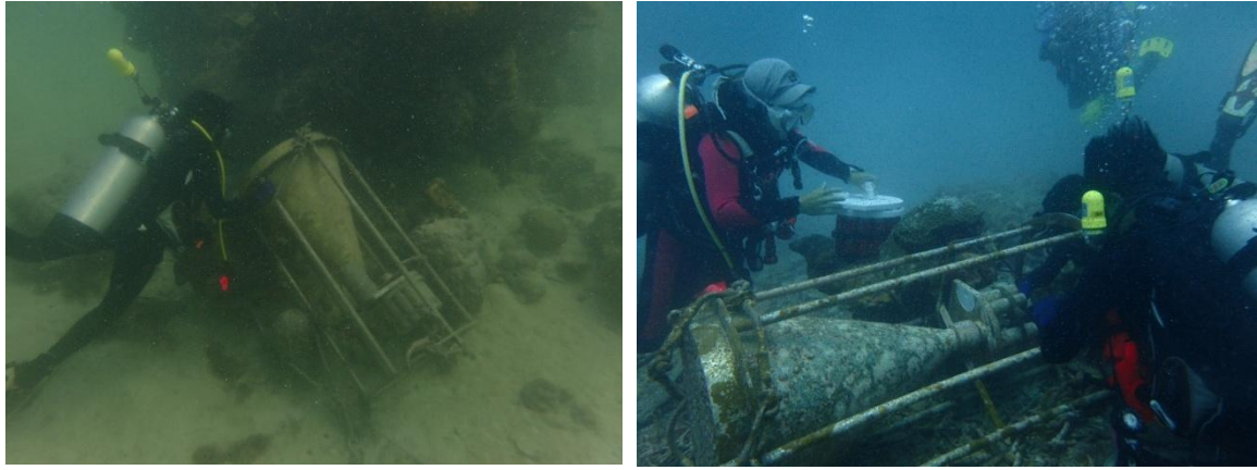
圖 4、作業人員利用環礁 6 號潛水回收 DSE2(左)跟 DSW2(右)錨碇式沉降顆粒收集器串列，其中 DSE2 呈現半傾倒狀態，而 DSEW2 則呈躺倒狀態。
