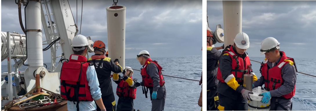
圖 2、NOR3-109 航次，Jul 20, 2022 於 H 站佈放 H-01 錨碇式沉降顆粒收集器
