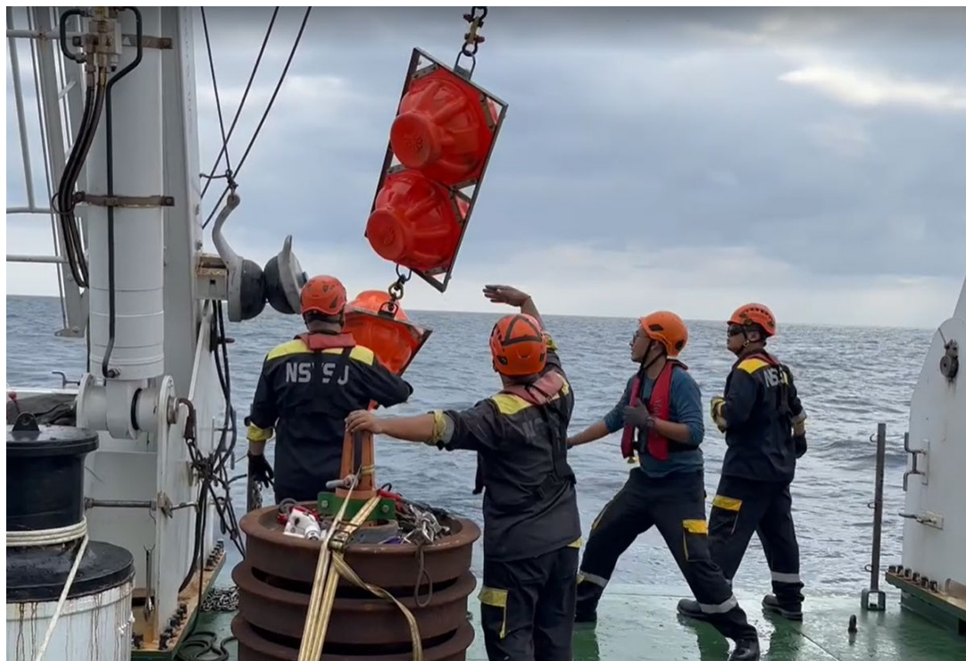
圖 3、NOR3-132 航次，Nov 16, 2022 於 H 站回收 H-01 錨碇式沉降顆粒收集器
