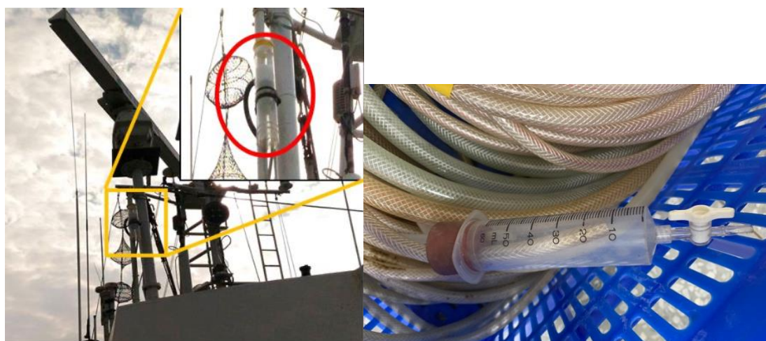
圖 8、空氣樣本進樣口與防水設施架設。
