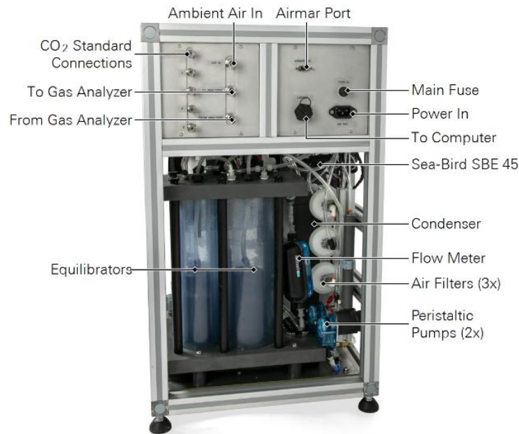
圖 6、二氧化碳分壓分析器氣體、電源線與訊號線示意圖（圖片取自官網手冊）。
