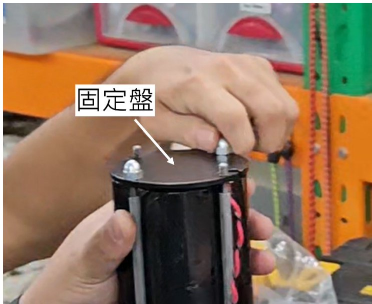
圖 2：擰開螺絲並取下固定盤
