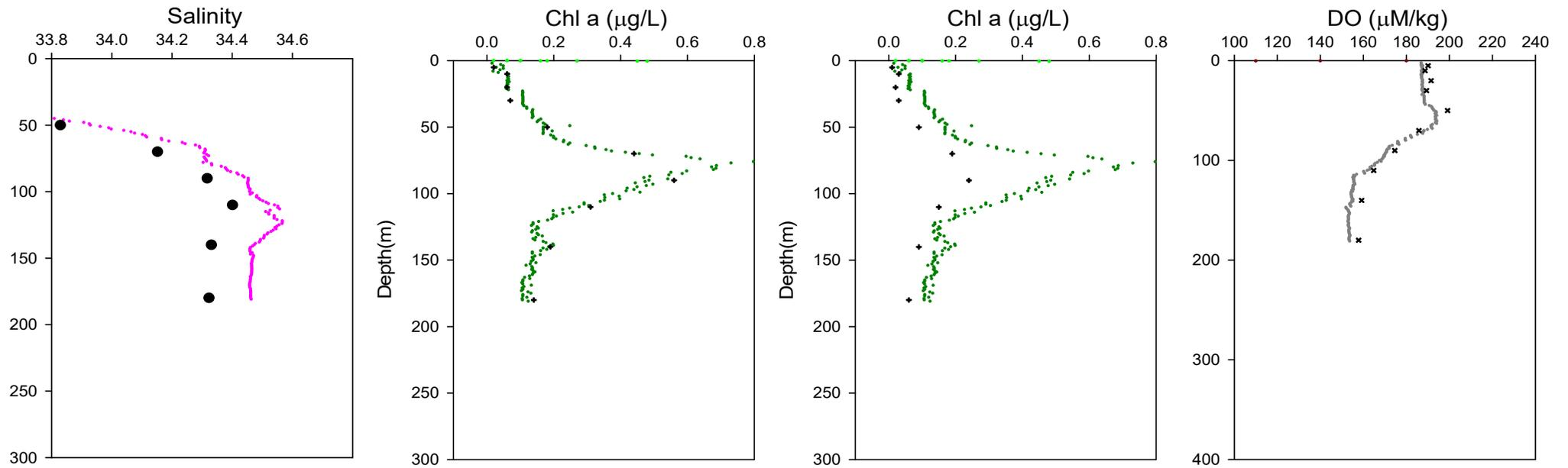
圖 3、(a) CTD 鹽度資料及實驗室實測資料對深度作圖，紫色點為 CTD 資料，黑色圓點為實驗室實測資料。(b) CTD 螢光資料及實驗室實測資料對深度作圖，綠色點為 CTD 資料，黑色十字點為實驗室實測資料 (排除脫鎂色素貢獻)。(c) CTD 螢光資料及實驗室實測資料對深度作圖，綠色點為 CTD 資料，黑色十字點為實驗室實測資料 (假設脫鎂色素影響可忽略)。(d) CTD 溶氧資料及實驗室實測資料對深度作圖，灰色點為 CTD 資料，黑色 X 點為實驗室實測資料。
