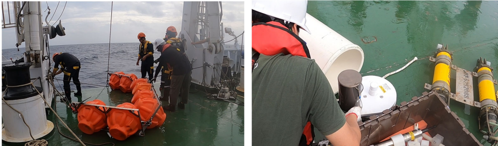
圖 3、NOR3-241 航次，Nov 14, 2024 於 T 站佈放錨碇式沉降顆粒收集器
