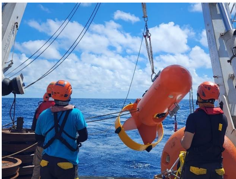
圖6.大型魚雷型浮材式浮球 StableMoor 於新海研3號施放情形
